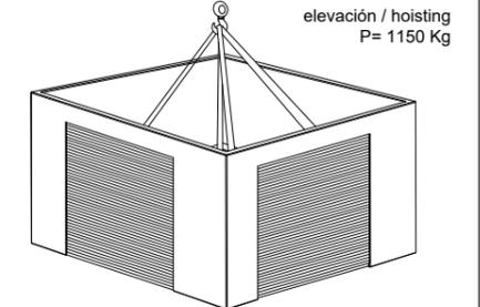
SISTEMA DE ELEVACIÓN / ANCHORAGE SYSTEM
