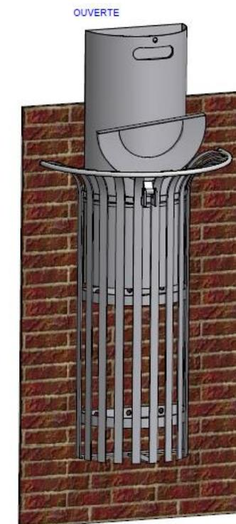
**Corbeille murale 1/2 TULIPE avec seau** - • Ensemble mécano-soudé en acier apte à la galvanisation à chaud • Galvanisation à chaud des produits finis (+/-55 microns) • Thermo laquage, poudre thermdurcissable à base de résine polyester (Minimum 60microns) • Mise à la teinte au choix dans nos collections RAL, RAL Fine Texture conseillé, Sablé conseillé. Hauteur 852mm - Largeur 564mm
