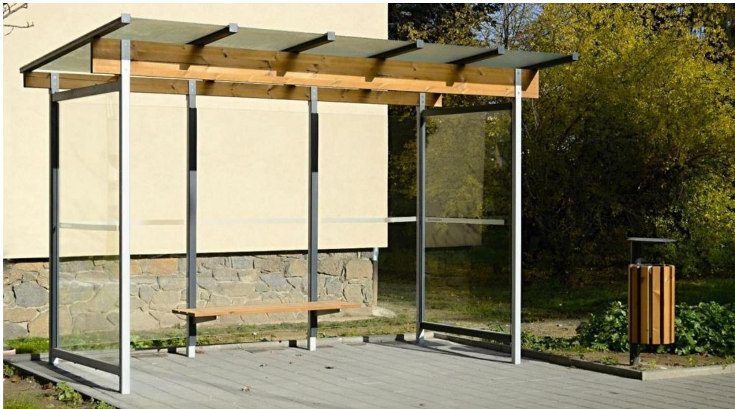
**Description** : Structure en acier et en tôle. La paroi arrière est en verre de sécurité renforcé (clair ou satiné), épaisseur 8mm. Les parois latérales sont en verre de sécurité renforcé (clair ou satiné), épaisseur 8mm. Le toit est constitué de poutres en bois retenant le verre de sécurité. L'assise est en bois de pin. L'ancrage au sol se fait par des tiges filetées de 330mm minimum.
