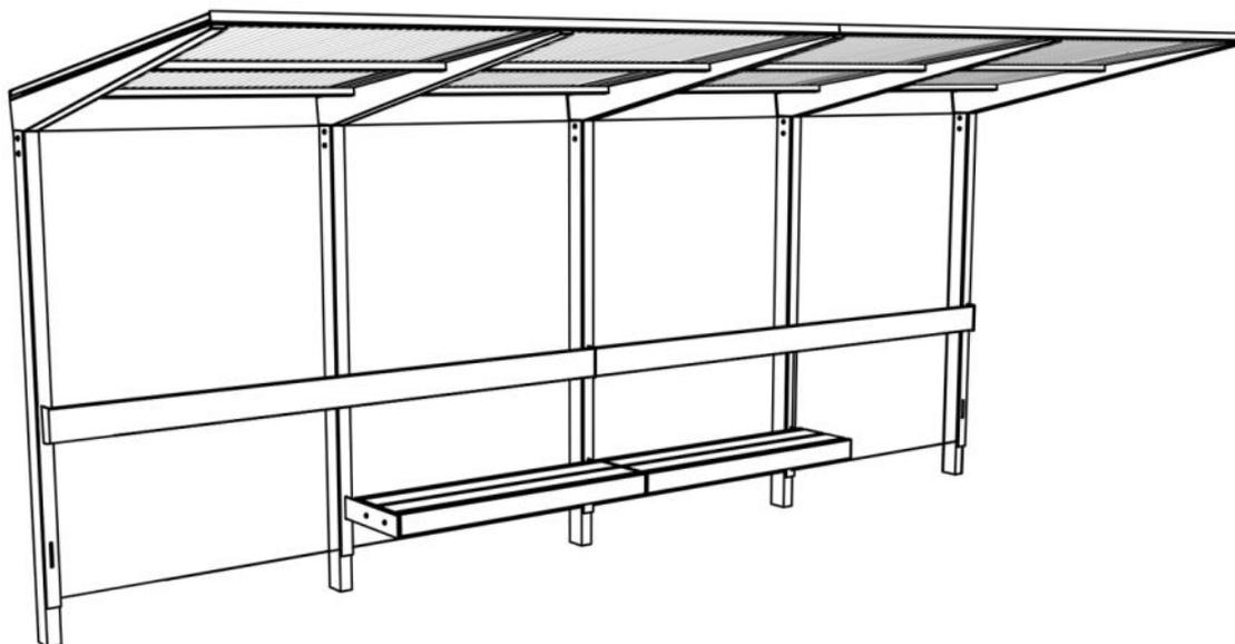
**Description** : Structure en acier galvanisé thermo laqué. La toiture est composé de panneaux en polycarbonate. La paroi arrière est un panneau en verre clair renforcé de 8 mm d'épaisseur. L'assise des deux banquettes sont composées chacune de 3 planches en bois tropical ou en bois de pin. Les planches de bois sont assemblées à la structure par des boulons en acier inoxydable.
