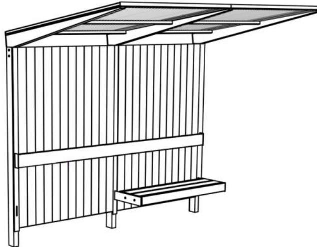
**Description :** Structure en acier galvanisé thermo laqué. La toiture est composé de panneaux en polycarbonate d'épaisseur 16 mm. La paroi arrière est composée de bois de pin ou bois tropical. L'assise de la banquette est composée de 3 planches en bois tropical ou en bois de pin. Les planches de bois sont assemblées à la structure par des boulons en acier inoxydable.
