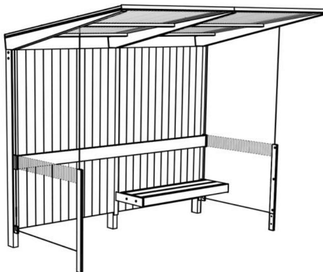
**Description** : Structure en acier galvanisé thermo laqué. La toiture est composée de panneaux en polycarbonate d'épaisseur 16 mm. La paroi arrière est composée de bois de pin ou bois tropical. Les parois latérales sont composées de panneaux en verre renforcé d'épaisseur 8 mm. L'assise de la banquette est composée de 3 planches en bois tropical ou en bois de pin. Les planches de bois sont assemblées à la structure par des boulons en acier inoxydable.
