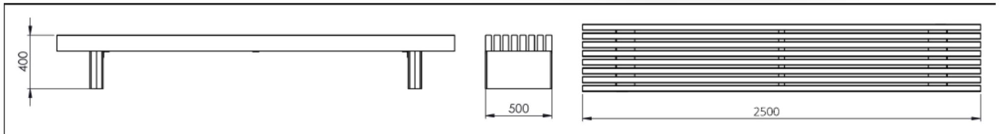
**Banquette SILEZIA** Piétement en acier galvanisé thermolaqué (RAL à définir selon la carte RAL standard). Le piétement est formé d'une tôle de 5 mm d'épaisseur. L'assise est formée de 8 lames en bois de Frêne de sections 120x45 mm et pourvues d'un chanfrein de 2x3mm. Installation : 4 tiges d'ancrage de M10. Visserie en acie inoxydable. Dimensions 2500x500x400 mm
