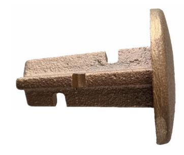
Pour une parfaite adhérence, nous recommandons comme pour tous types de clous de remplir la coupelle de colle lors de la pose. Patte de scellement en triangle de longueur 40mm. La patte de scellement fait prtie intégrante du clou. Elle est conçue pour résister aux girations des véhicules.
