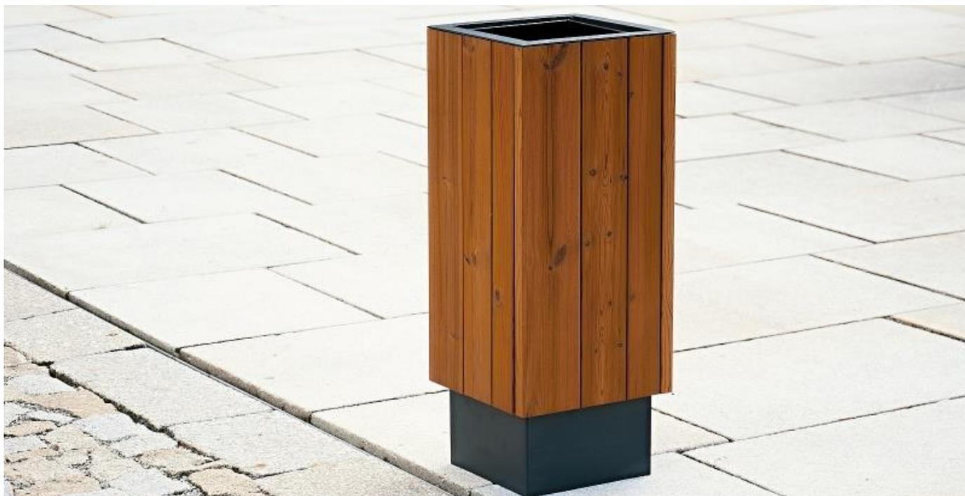
**Description :** Structure en acier galvanisé. L'habillage est fait de planches en bois de : Chêne, Épicea, Pin thermo traité ou Bois Tropical. Les planches de bois sont assemblées à la structure par des boulons en acier inoxydable. Le bac en polypropylène de 5 mm d'épaisseur est amovible.
