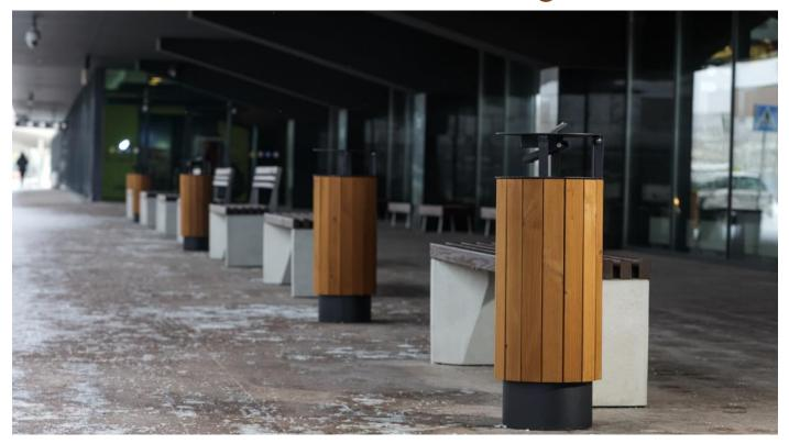
**Description**: Structure en acier galvanisé. La corbeille dispose d'une protection en acier galvanisé. L'habillage est fait de planches en bois de : Chêne, Épicea, Pin thermo traité ou Bois Tropical. Les planches de bois sont assemblées à la structure par des boulons en acier inoxydable. Le bac en acier galvanisé de 8 mm d'épaisseur est amovible.
