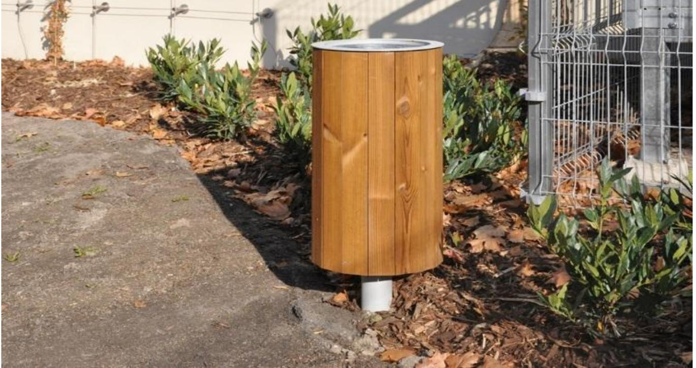
**Description :** Structure en acier galvanisé sur pied central circulaire. L'habillage est fait de planches en bois de : Chêne, Épicea, Pin thermo traité ou Bois Tropical. Les planches de bois sont assemblées à la structure par des boulons en acier inoxydable. Le bac en acier galvanisé de 8 mm d'épaisseur est amovible.
