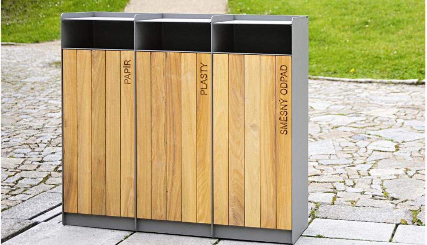
**Description :** Structure en acier galvanisé. L'habillage à l'avant est fait de 15 planches en bois (chêne, épicea, bois exotique ou pin). La corbeille dispose d'une protection. Les côtés et l'arrière sont en acier galvanisé. Les bacs en polypropylène de 5 mm d'épaisseur sont amovibles.
