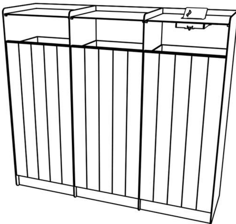
**Description :** Structure en acier galvanisé. L'habillage à l'avant est fait de 15 planches en bois (chêne, épicéa, bois exotique ou pin). La corbeille dispose d'une protection, d'un étouffoir à cigarettes et d'un cendrier en inox 304. Les côtés et l'arrière sont en acier galvanisé. Les bacs en polypropylène de 5 mm d'épaisseur sont amovibles.
