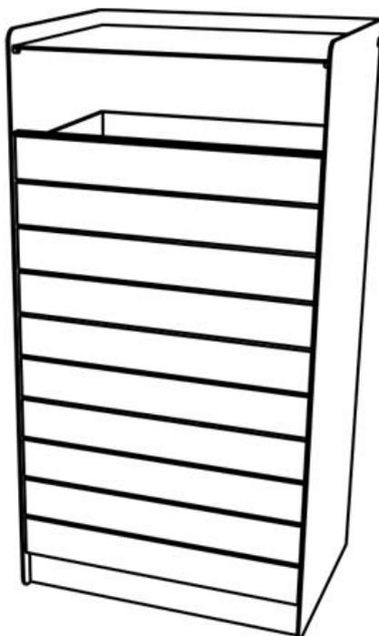
**Description :** Structure en acier galvanisé. L'habillage à l'avant est fait de 10 planches en bois (chêne, épicea, bois exotique ou pin) mises à l'horizontale. Les côtés et l'arrière sont en acier galvanisé. La corbeille dispose d'une protection. Le bac en polypropylène de 5 mm d'épaisseur est amovible.
