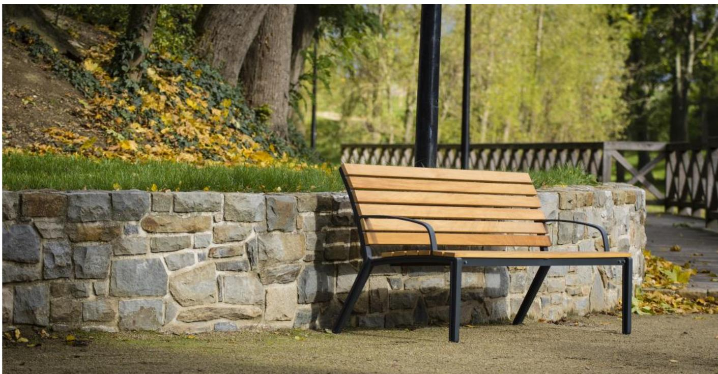
**Description :** Structure en aluminium brut. Le dossier et l'assise sont composés respectivement de 6 planches en bois de : chêne, épicéa ou bois tropical. Les planches de bois sont assemblées à la structure par des boulons en acier inoxydable.
