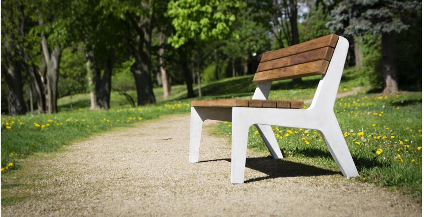
**Description :** Structure en acier galvanisé reliant les piétements en béton C 30/37. L'assise et le dossier sont composés respectivement de 5 et 3 lames en bois de chêne, de dimension 70x40mm, fixés à la structure par des vis inox M8.
