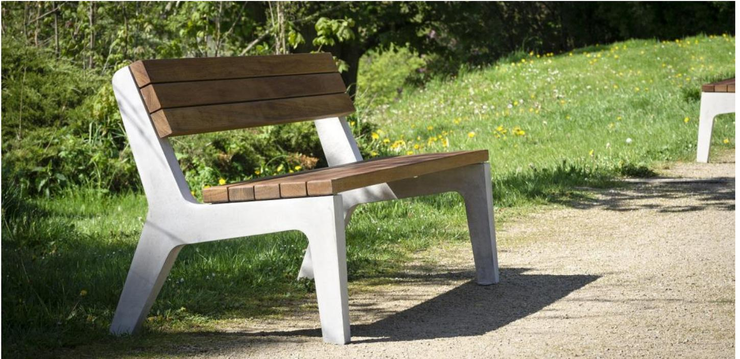
**Description :** Structure en acier galvanisé reliant les piétements en béton C 30/37. L'assise et le dossier sont composés respectivement de 5 et 3 lames en bois tropical, de dimension 70x40mm, fixés à la structure par des vis inox M8.
