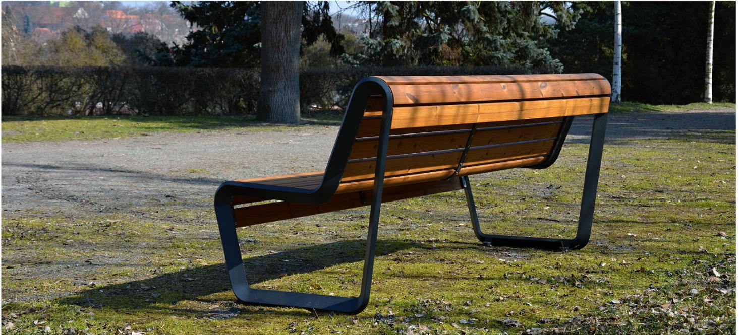
**Description :** Structure en aluminium **thermolaqué**. Le dossier et l'assise sont composés respectivement de 10 planches de section rectangulaire et 6 planches cintrées en bois de : chêne, épicéa ou bois tropical. Les planches de bois sont assemblées à la structure par des boulons en acier inoxydable.
