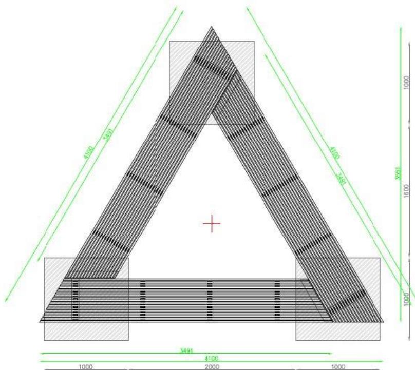
**Description** : Structure en acier galvanisé. L'assise est composée de 15 lames rectangulaires en bois tropical. Les lames sont mises à la verticale de dimension avec une longueur qui varie de 2919-3491mm. Lorsque les 3 bancs sont assemblés pour réaliser un triangle, cela donne un triangle équilatérale de 4100mm de côté.
