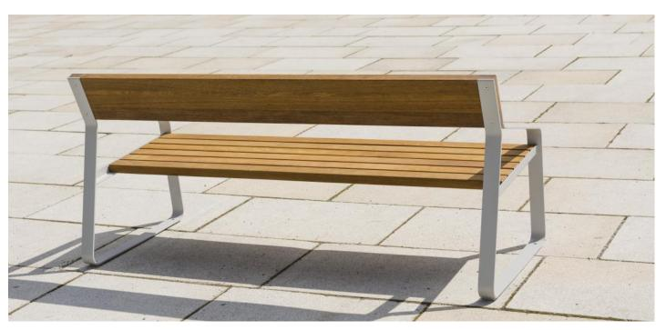
Description : Structure et piétement en acier galvanisé thermo laqué. Les piétements sont soudés au cadre du banc. Le dossier et l'assise sont composés respectivement de 1 planche et 6 planches en bois de pin. Les planches de bois sont assemblées à la structure par des boulons en acier inoxydable.
