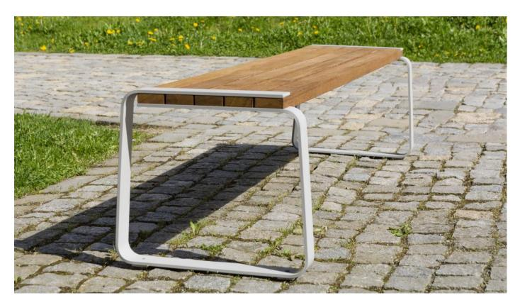
**Description** : Structure et piétement en acier galvanisé thermo laqué. Les piétements sont soudés au cadre du banc. L'assise est composée de 6 planches en bois de pin. Les planches de bois sont assemblées à la structure par des boulons en acier inoxydable.
