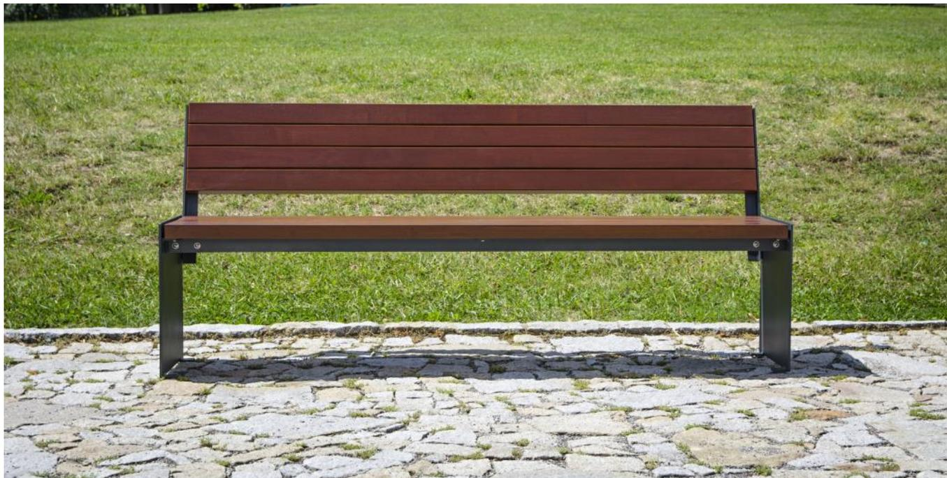
**Description :** Structure et piétement en acier galvanisé thermo laqué. Les piétements de 6 mm de large sont soudés au cadre du banc de profile 40x40 mm. Le dossier et l'assise sont composés respectivement de 6 planches rectangulaire de 70x40 mm et 4 planches rectangulaire de 70x40 mm en bois d'épicéa. Les planches de bois sont assemblées à la structure par des boulons en acier inoxydable.
