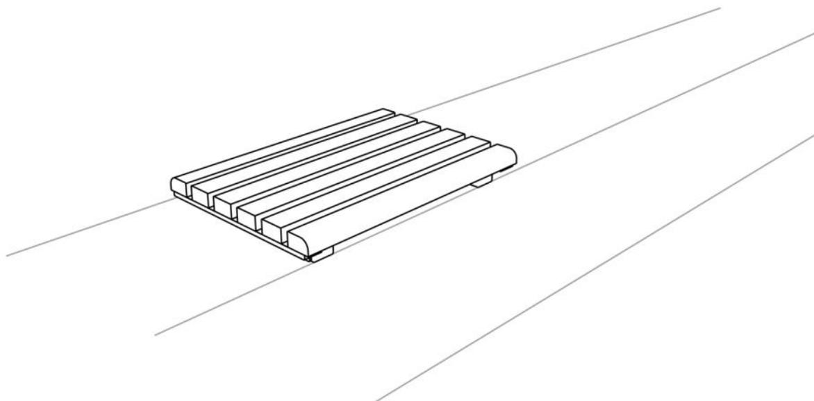
**Description** : Structure en acier galvanisé. L'assise est composée de 6 lames de bois de dimension 56x32x1800mm. Les deux lattes aux extrémités sont arrondis. La structure se fixe au mur existant avec des pièces en acier de dimension 50x25mm.
