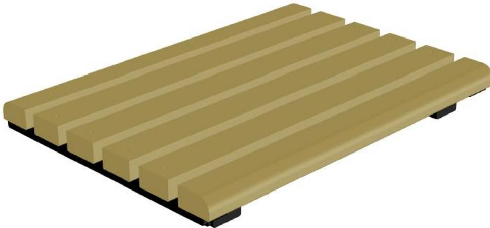
**Description :** Structure en acier galvanisé. L'assise est composée de 6 lames de bois de dimension 56x32x600mm. Les deux lattes aux extrémités sont arrondis. La structure se fixe au mur existant avec des pièces en acier de dimension 50x25mm.
