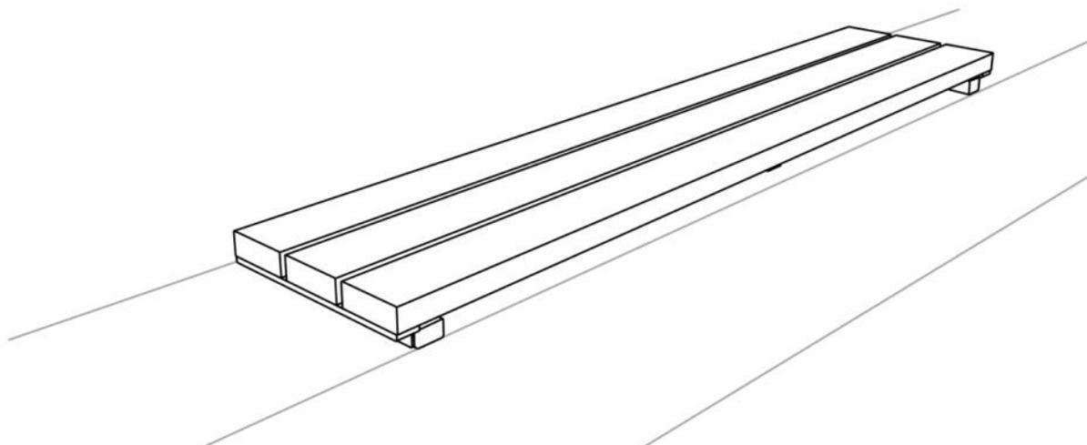
**Description** : Structure en acier galvanisé. L'assise est composée de 3 lames de bois de dimension 117x52x1800mm. La structure se fixe au mur existant avec des pièces en acier de dimension 50x25mm
