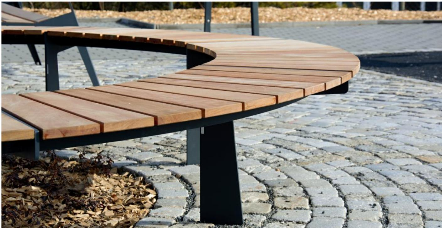
**Description :** Banquette circulaire. Structure en acier soudé thermo laqué ép. 5mm. Piétement en tôle d'acier thermo laqué ép. 8 mm, les piétements sont attachés à la structure par trois vis M8 en acier galvanisé thermo laqué. L'assise est composée de 9 lames de longueurs 440 mm en bois de : Chêne, Épicea, Pin thermo traité ou Bois Tropical. Les planches de bois sont assemblées à la structure par des boulons en acier inoxydable.
