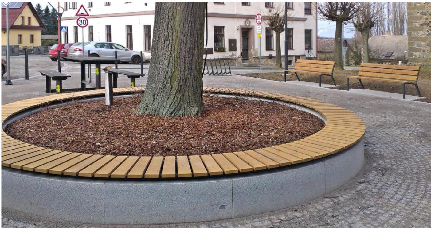
**Description :** Banc circulaire pour mur en béton. Structure en morceaux de tôle d'acier thermo laqué ép. 5mm. Les morceaux de tôle sont fixés entre eux par 3 vis M8. L'assise est composée de 12 lames de longueurs 440 mm en bois de : Chêne, Épicea, Pin thermo traité ou Bois Tropical. Les planches de bois sont assemblées à la structure par des boulons en acier inoxydable.
