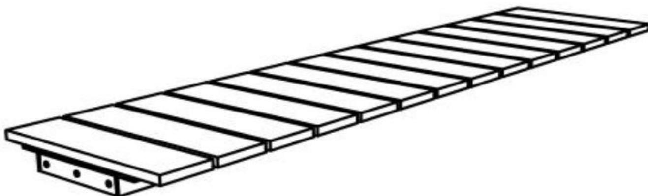
**Description :** Banquette circulaire pour mur en béton. Structure en morceaux de tôle d'acier thermo laqué ép. 5mm. Les morceaux de tôle sont fixés entre eux par 3 vis M8. L'assise est composée de 14 lames de longueurs 440 mm en bois de : Chêne, Épicea, Pin thermo traité ou Bois Tropical. Les planches de bois sont assemblées à la structure par des boulons en acier inoxydable.
