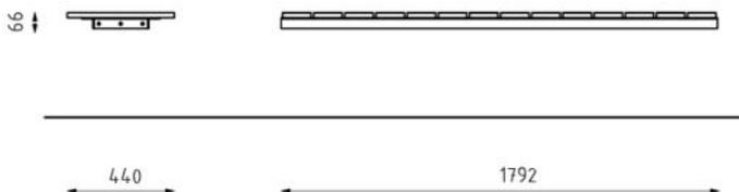
**Ancrage :** L'ancrage se fait avec 4 tiges M10 de longueur minimum 100 mm et de 4 écrous M10 dans le mur en béton de 400 mm de hauteur ayant la même forme que le banc.
