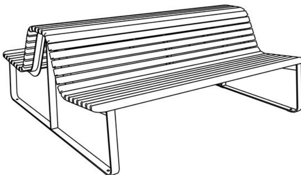
**Description** : Structure en acier soudé. Les piétements sont composés de deux rails soudés à partir d'une bande pliée de 50x8 mm et de tôle de 5 mm d'épaisseur. La double assise et le dossier sont composés de 2 lames rectangulaire de 70x 32x1800 mm et de 33 lames rectangulaire de 40x32x1800 mm en bois tropical traité. Les planches de bois sont assemblées à la structure par des boulons en acier inoxydable.
