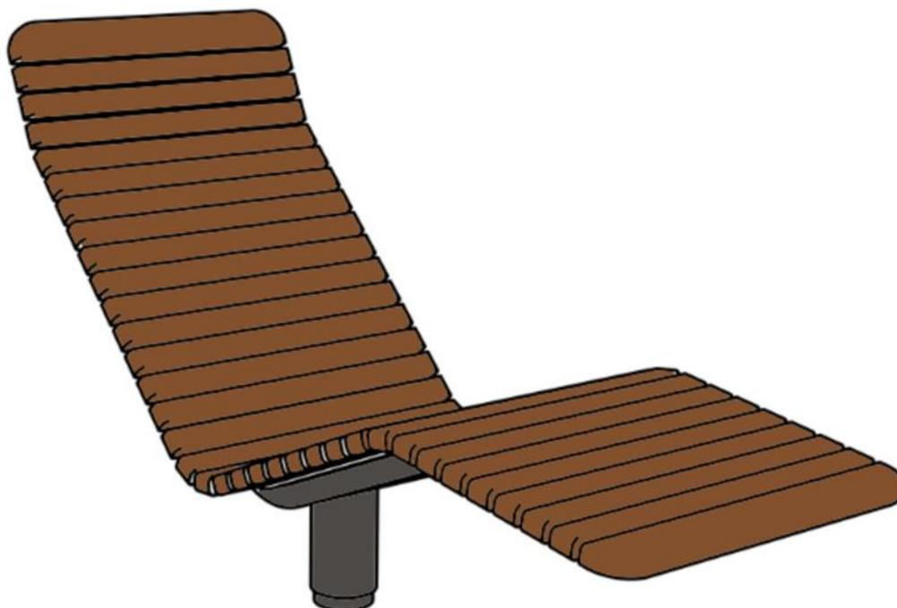
**Description** : Structure en acier soudé. Le piétement rotatif à 360 °, la rotation se bloque quand une personne est allongée sur la chaise longue. L'assise et le dossier sont composés de 2 lames rectangulaire de 70x32 mm et de 6 lames rectangulaire de 40x32 mm en bois tropical traité. Les planches de bois sont assemblées à la structure par des boulons en acier inoxydable.
