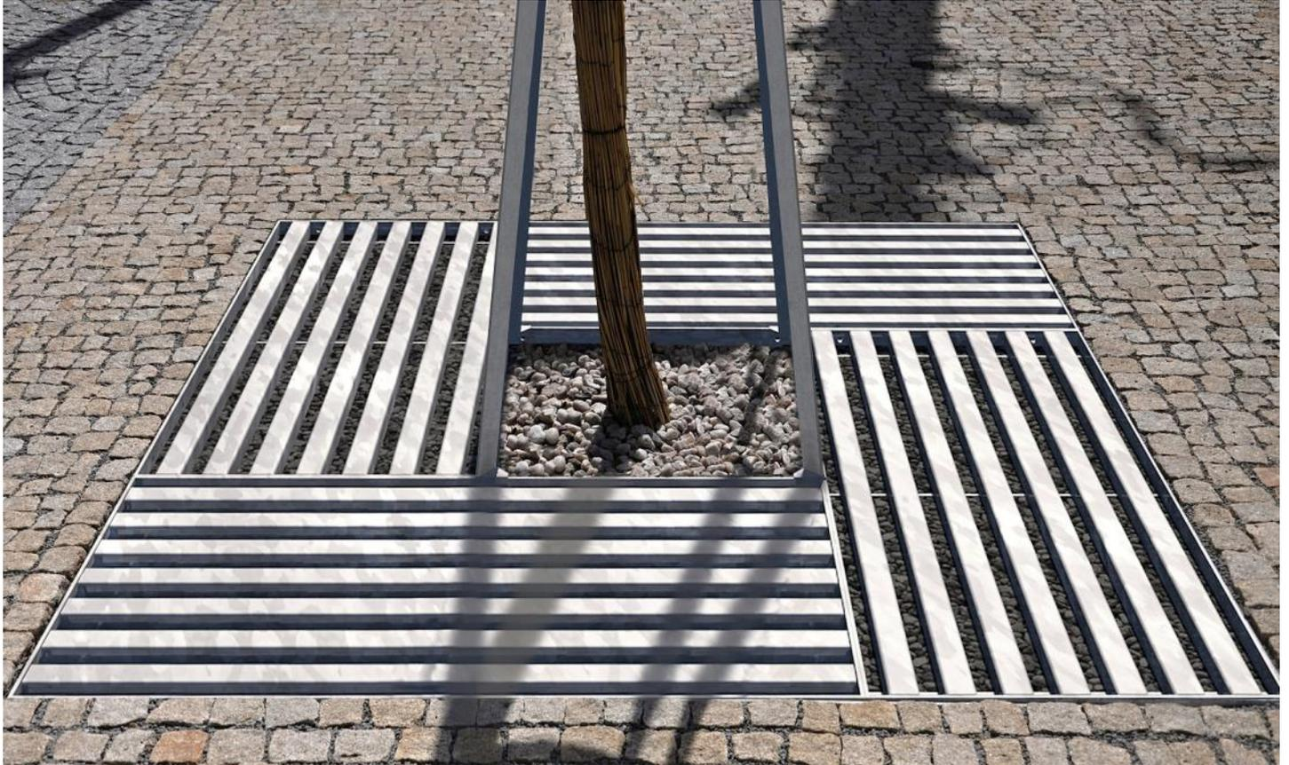
**Description** : La structure est en acier. Le cadre se compose de 4 segments joints dans lesquels sont placés 4 grilles avec des bandes d'acier de 40x4mm.
