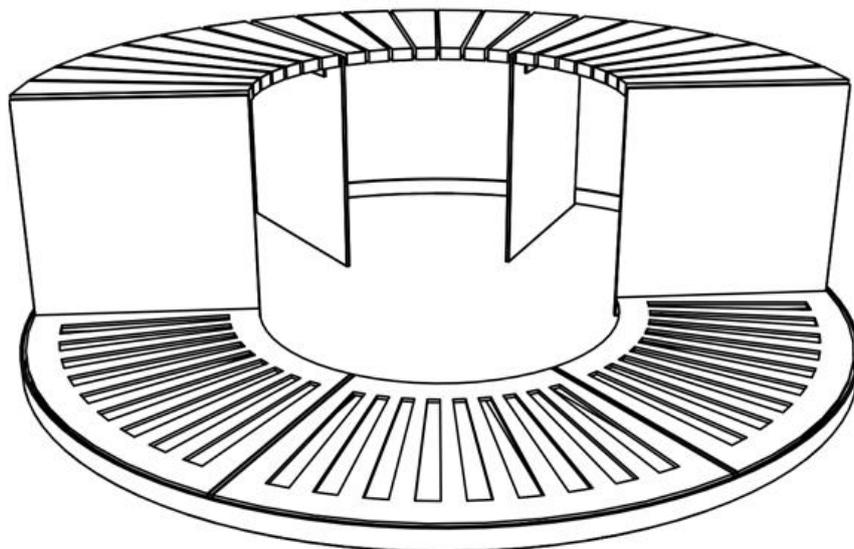
**Description :** Système de grille d'arbre modulaire composé d'un cadre circulaire en acier, 3 assises en bois (chêne, épicéa, bois exotique, pin) et 3 grilles. L'assise des bancs est composée de 7 lattes en bois.
