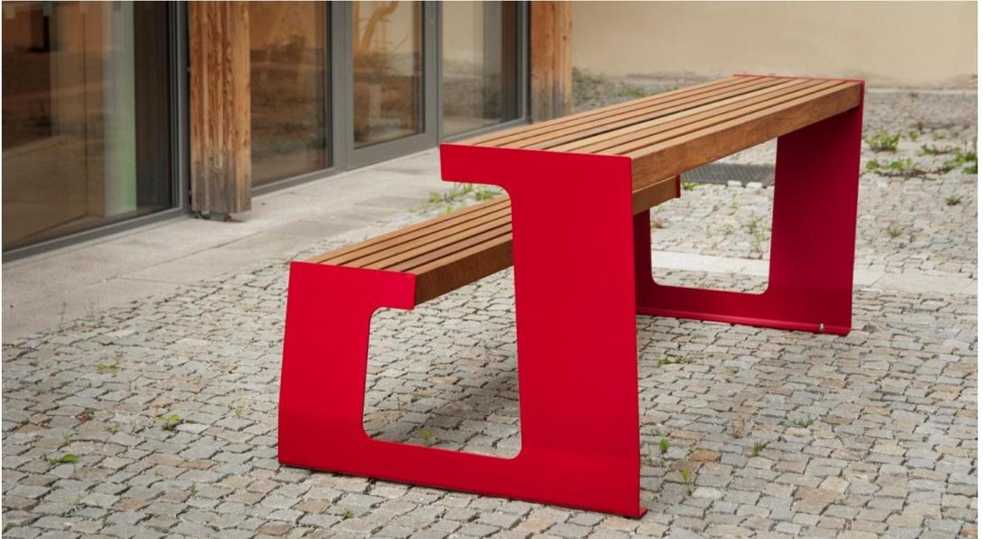
**Description** : La structure est en acier galvanisé. L'assise et la table sont faites de lames de bois attachées à la structure par une visserie en acier inoxydable. Les piétements sont fait en tôle d'acier de 4 à 6mm d'épaisseur. Les lames de bois sont de dimension 70x40mm pour une longueur de 1378mm pour la table et 1134mm pour l'assise.
