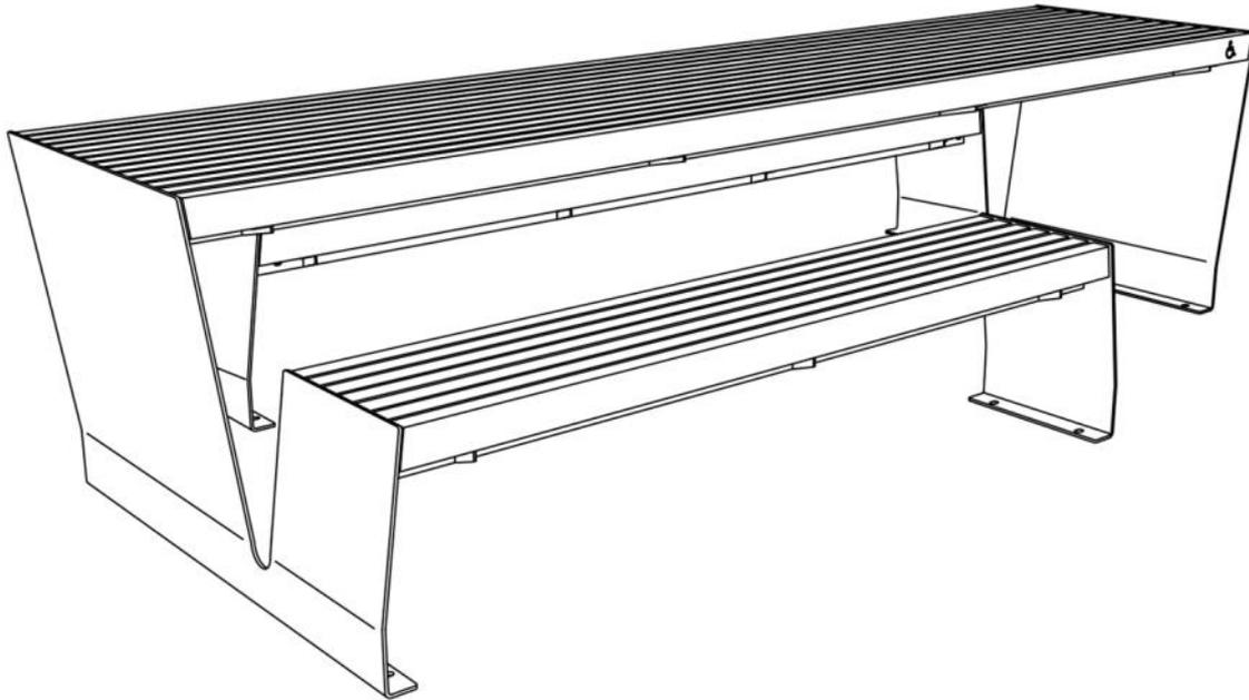
**Description** : La structure est en acier galvanisé. L'assise et la table sont faites de lames de bois attachées à la structure par une visserie en acier inoxydable. Les piétements sont fait en tôle d'acier de 4 à 6mm d'épaisseur. Les lames de bois sont de dimension 70x40mm pour une longueur de 2978mm pour la table et 2334mm ou 1734mm pour l'assise. La table possède un emplacement PMR.
