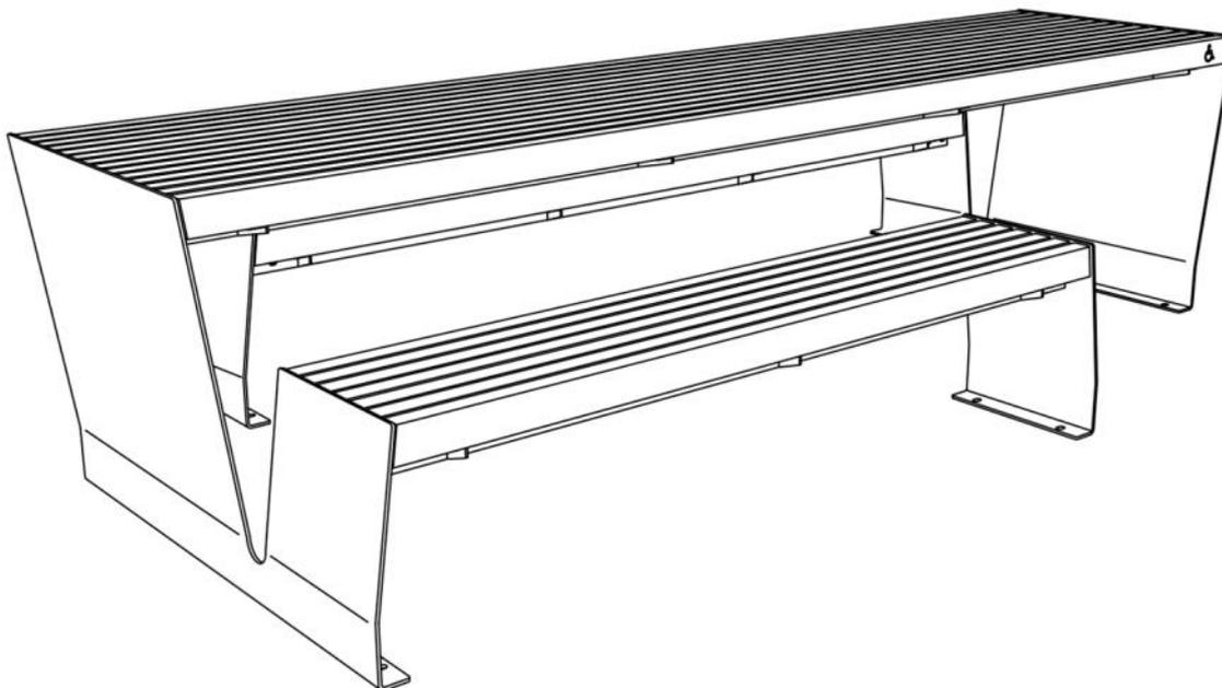
**Description** : La structure est en acier galvanisé. L'assise et la table sont faites de lames de bois attachées à la structure par une visserie en acier inoxydable. Les piètements sont fait en tôle d'acier de 4 à 6mm d'épaisseur. Les lames de bois sont de dimension 70x40mm pour une longueur de 2978mm pour la table et 2334mm ou 1734mm pour l'assise. La table possède un emplacement PMR.
