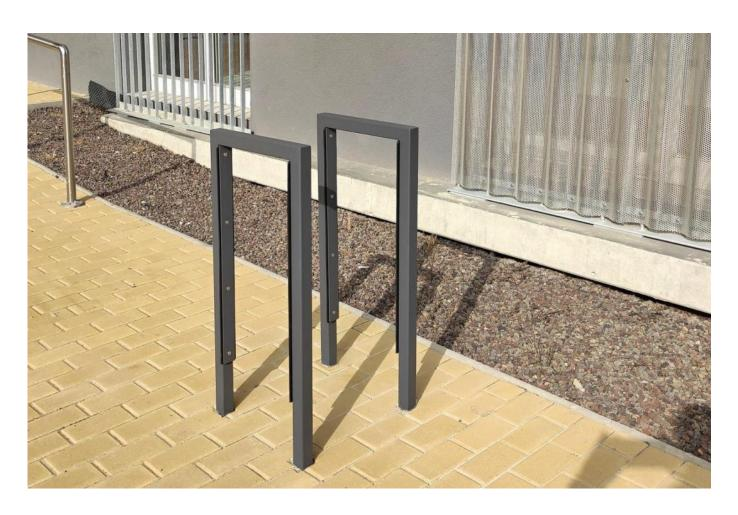
**Description**: Structure en acier soudé 40x40x3mm. A l'intérieur de la structure, un ruban de caoutchouc (dimension 50x5mm) est fixée afin de protéger la peinture des vélos. Fixation sur platines par tiges filetées M10.
