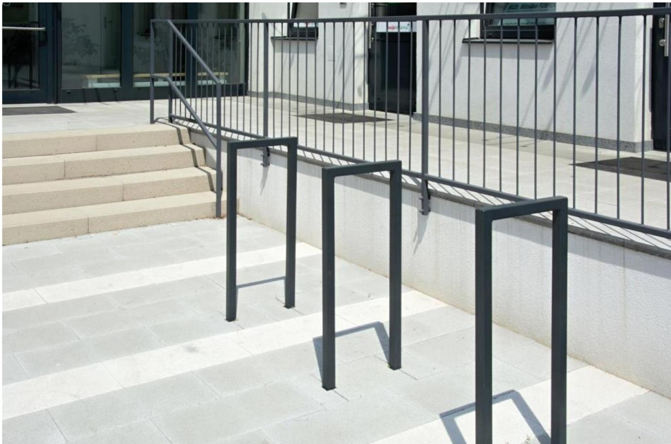
**Description** : Structure en acier soudé 40x40x3mm. Fixation sur platines par tiges filetées M10.
