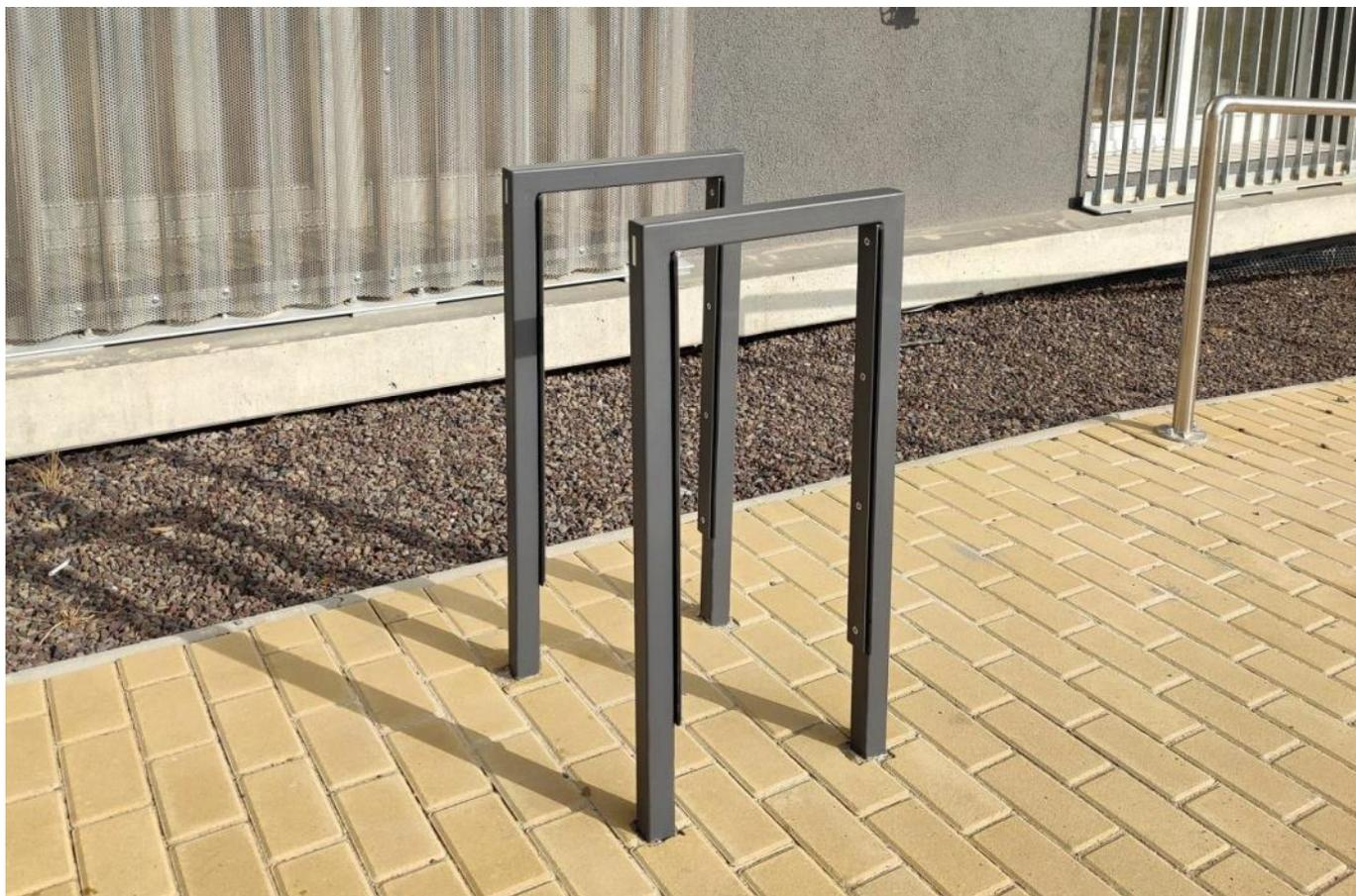
**Description** : Structure en acier soudé 40x40x3mm. A l'intérieur de la structure, un ruban de caoutchouc (dimension 50x5mm) est fixée afin de protéger la peinture des vélos. Fixation sur platines par tiges filetées M10.
