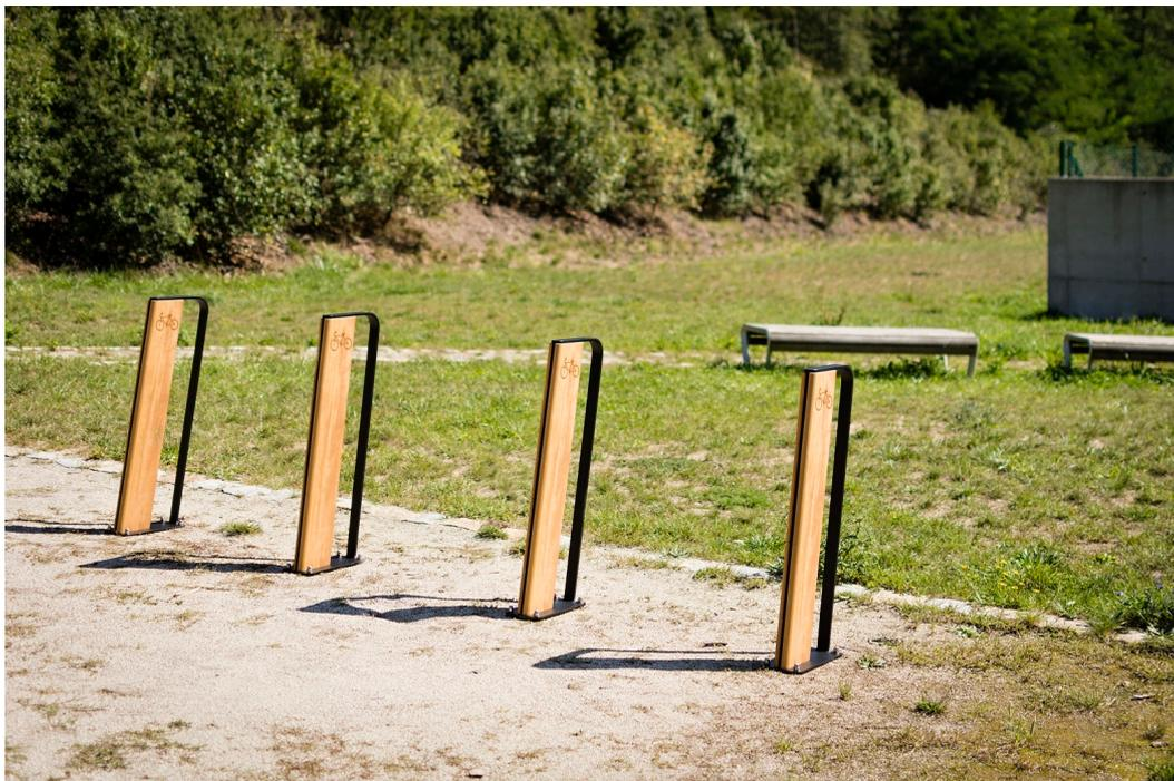
**Description :** La structure est faite en acier galvanisé thermo laqué, deux planches de bois d'acacia sont attachées de chaque côté de la structure de tel sorte que le cadre du vélo ne touche pas la structure. Fixation sur platines par tiges filetées M10.
