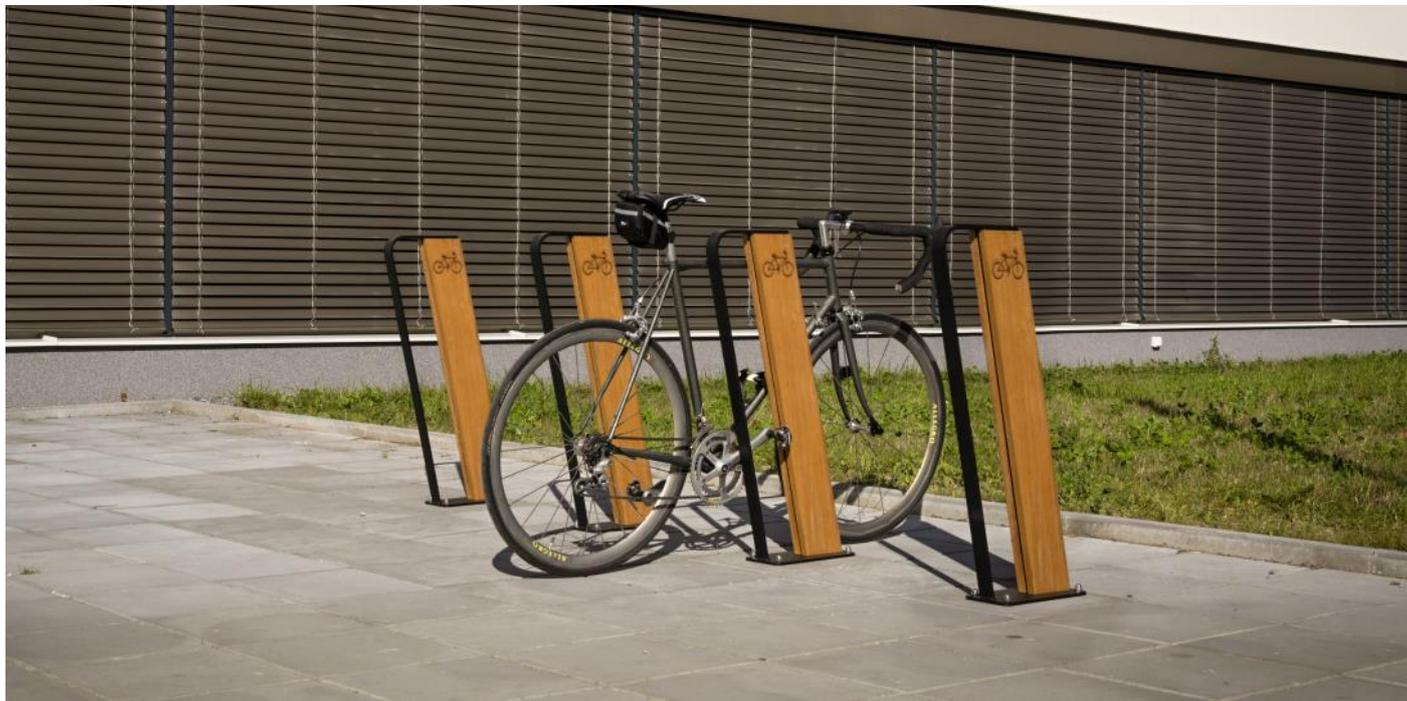
**Description** : La structure est faite en acier galvanisé thermo laqué, deux planches de bois tropical sont attachées de chaque côté de la structure de tel sorte que le cadre du vélo ne touche pas la structure. Fixation sur platines par tiges filetées M10.
