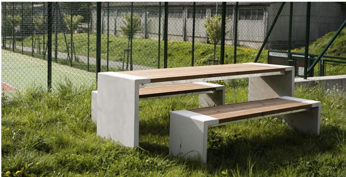
**Description :** La structure est faite en béton de classe C 30/37. La table est composée de 6 planches de 42 mm de hauteur, 117 mm de largeur et 1430 mm de longueur, en bois de : Chêne ou Pin thermo traité avec la solution Thermowood. Les planches de bois sont assemblées à la structure par des écrous M8.
