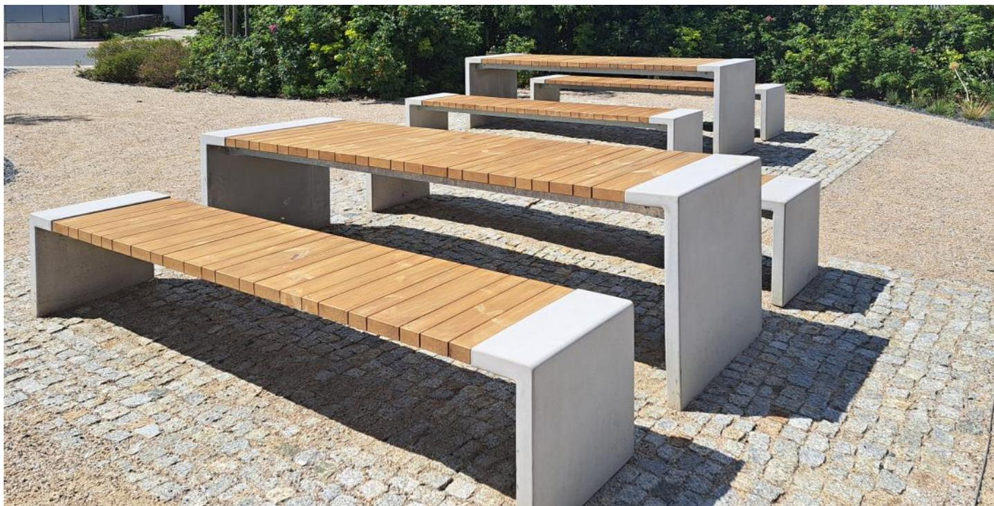
**Description :** La structure est faite en béton de classe C 30/37. La table est composée de 15 planches en bois de : Chêne ou Pin thermo traité avec la solution Thermowood. Les planches de bois sont assemblées à la structure par des écrous M8.
