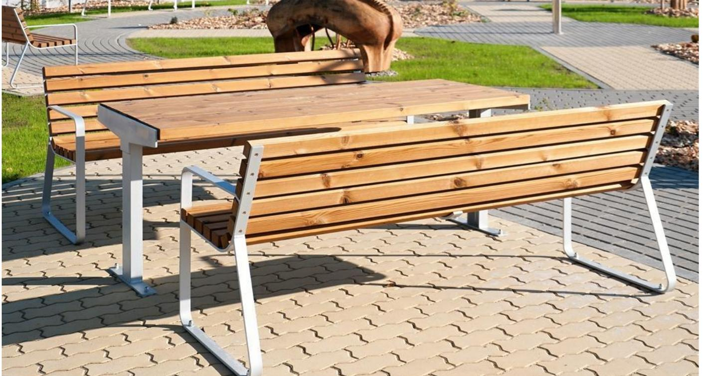
**Description :** La structure est en acier. La table possède deux pieds aux extrémités. Elle est faite de 6 lamelles de bois (chêne, épicéa, pin) d'une dimension de 117x42mm. Elles sont fixées à la structure par une visserie en inox.
