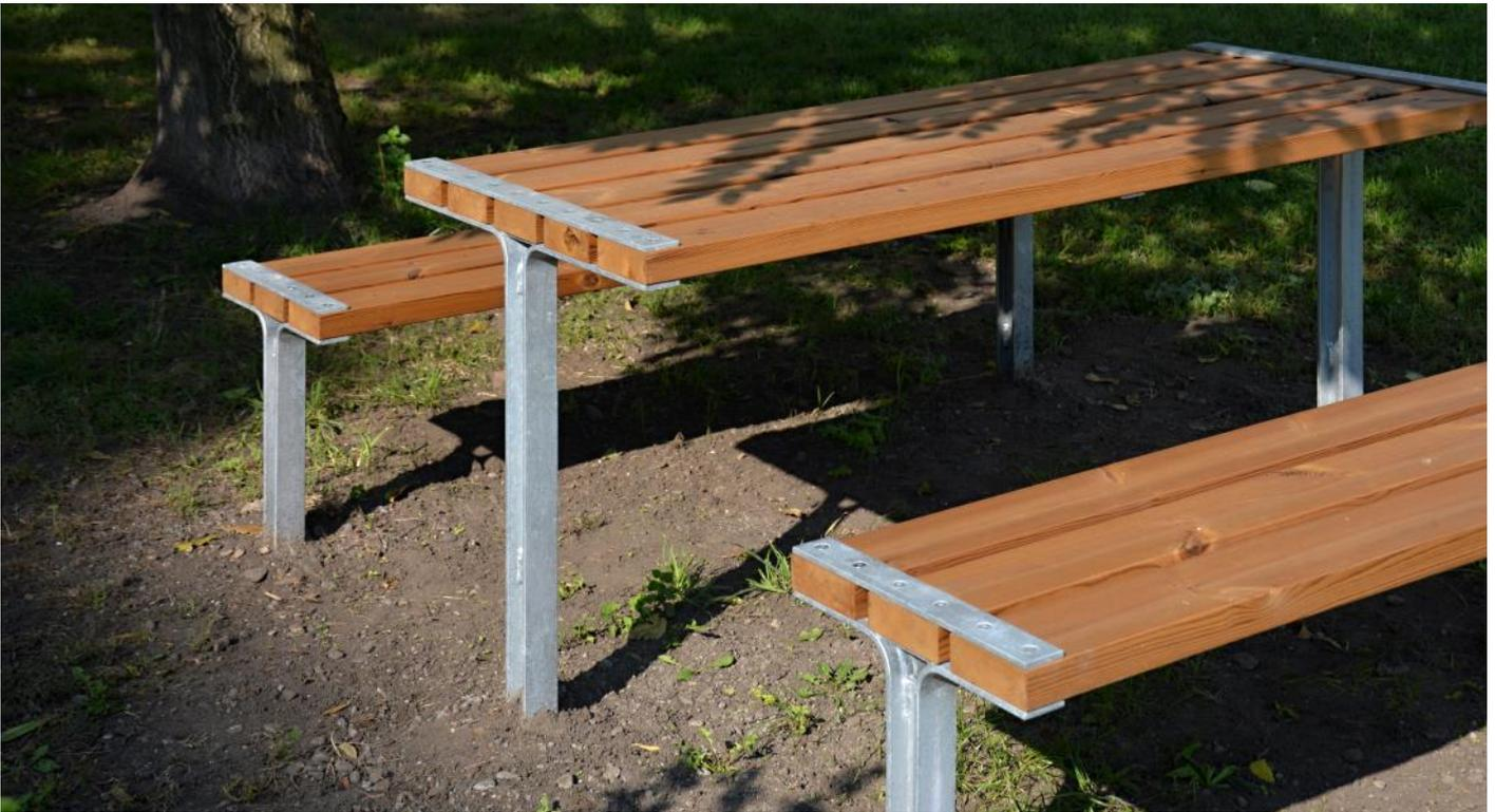
**Description** : La structure est faite de deux rails en acier de 50x10mm. La table est composée de 5 planches de 42 mm de hauteur, 117 mm de largeur et 1800 mm de longueur, en bois de : épicéa ou Pin thermo traité avec la solution Thermowood. Les planches de bois sont assemblées à la structure par des écrous M8.
