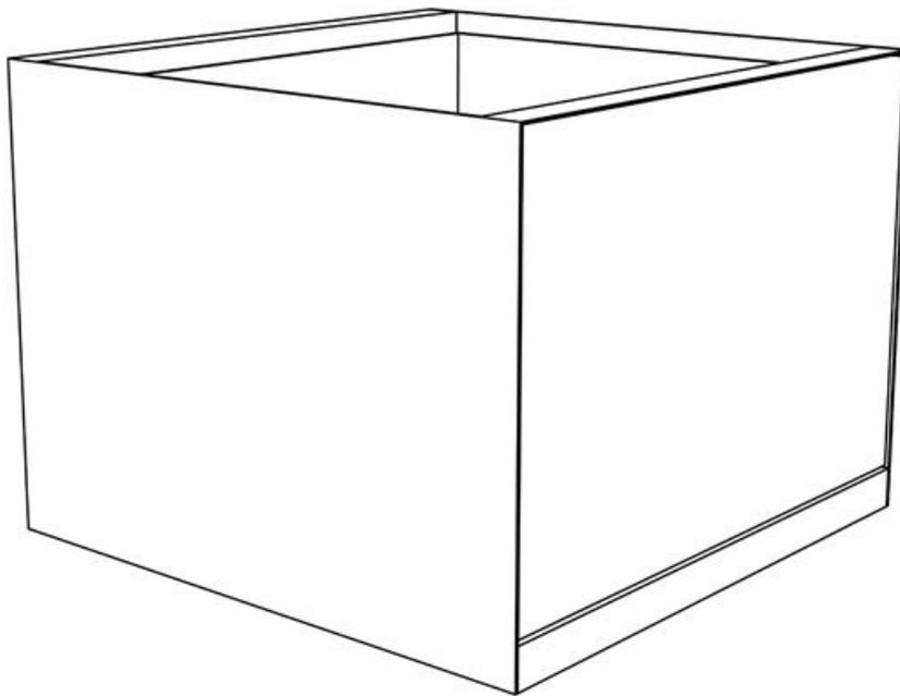
**Description** : Structure en acier galvanisé. La jardinière est composée de 2 plaques latérales en tôle de 4mm d'épaisseur. L'avant est un panneau en tôle galvanisée et thermolaquée. A l'intérieur de la jardinière, le bac en polypropylène de 5 mm d'épaisseur est amovible.
